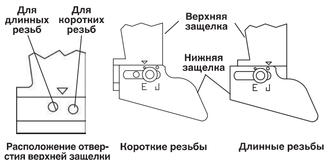
Рис. 18 – Настройка длины резьбы
